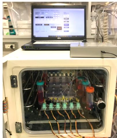
Fig. 6 開発中の灌流培養装置
