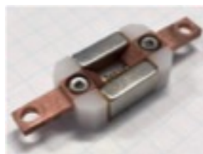
図 1. 超伝導ダイオード素子の外観。
