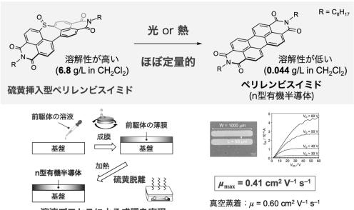
溶液プロセスによる成膜を実現
