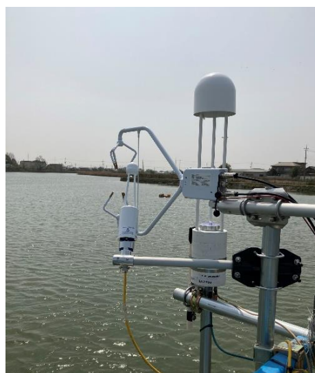
図 1 渦相関法によるメタン・二酸化炭素ガス交換量の測定の様子
