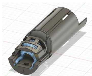
図4 マーモセット用MRI保定器の設計図面
