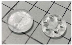
どちらの構造体についても、異常接着や構造破綻などが発生していないことから、構造模擬として材料が成功していることを確認した。今後、人工肺としての性能試験を行い、さらなるブラッシュアップを行い、人工臓器学会にて発表することを予定している。
