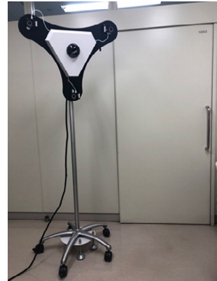
図 4 外来ブースに設置した簡易型可動式動作解析装置 MA-3000
