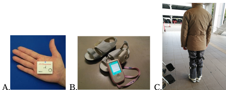
図1. A：慣性センサ、B：荷重計を搭載した靴、C：屋外測定環境
