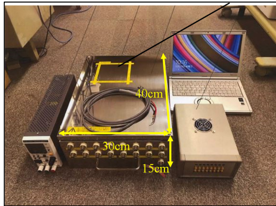
図-8 試作した半導体小型検出器（ノートパソコン程度の検出器開発に成功した）
