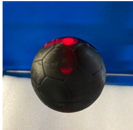
図4 サッカーボール模型の磁力支持
