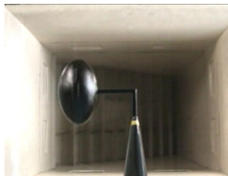
図1 ラグビーゴールキックの風洞試験 ボール内部にモータを組み込み、短軸周りに回転する。支柱が風にさらされ、流れを乱してしまう(支持干渉)。
