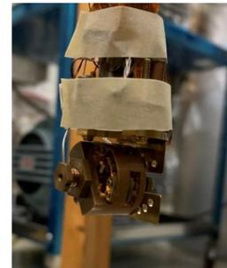
図 3: 自作した膨張計 2 号機。測定方向が水平方向と平行になるように冷凍機に取り付けたときの様子（右）。
