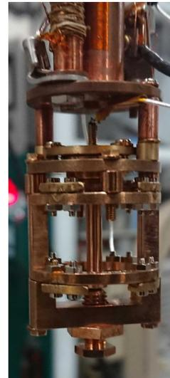
図 2: 自作した膨張計 1 号機。
