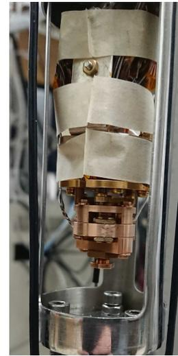
図 4: 自作した膨張計 3 号機。
