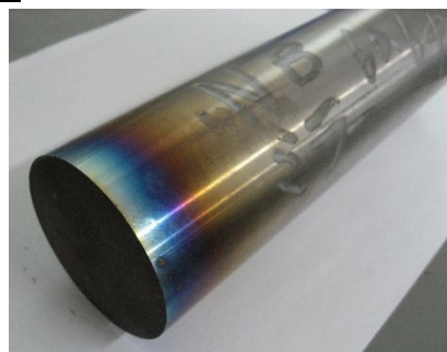
図 2: 導波管製作に用いる Nb 材の丸棒
