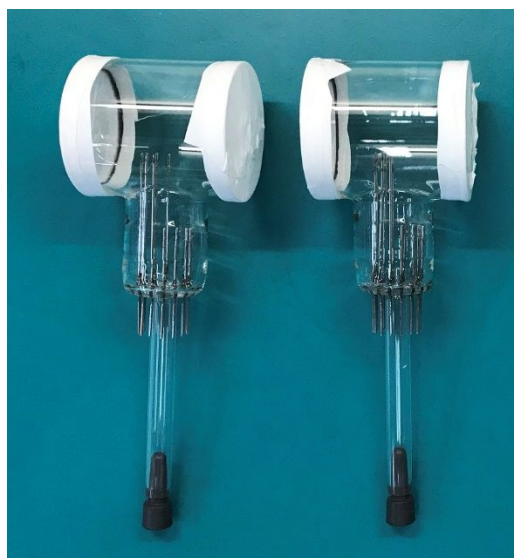
図 1. 直径 35mm，長さ 40mm の吸収セル試作品 それぞれのセルに 13 本のタングステンフィラメントが設置されている．
