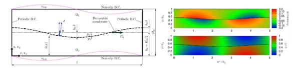
また潤滑が支配的な環境下で、可変形セル状粒子の表面における膜透過流束を解く数値解法を開発した。狭隘路を通過する際に発生する潤滑に由来する圧、膜形状の変形、および膜透過流束が互いに影響を及ぼすことを示し、潤滑が衡輸送現象に与える影響の一端を明らかにした。
