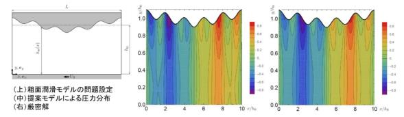
解を、移動平板と粗面の間の流れを例にとって上の図に示す。左図の問題設定に対して、 提案手法で得られる圧力分布(中図)を厳密解(右図)と比較し、粗面狭隘路の壁垂直方 向分布の特徴を再現することを確認した。
