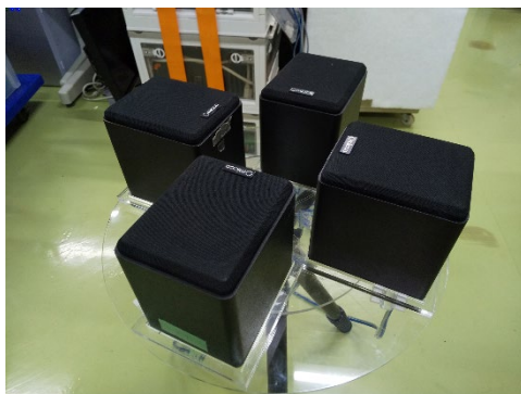
図7：4台のスピーカによる双極子音源
