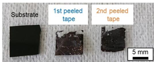
図5 5層積層膜の剥離後の外観写真
