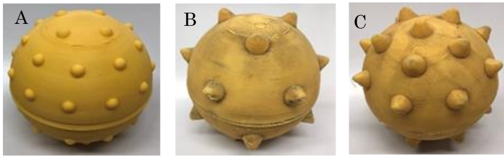
図 1. 角の種類が異なる小型球体ロボット A:角の高さ 0.3 cm 50 個、B:角の高さ 1.0 cm 18 個、 C:角の高さ 1.0 cm 28 個
