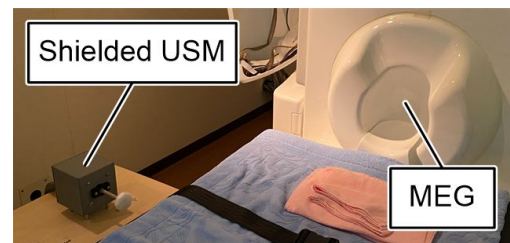
図 3. 磁気シールドを用いたアクチュエーションシステムの MEG 対応試験
