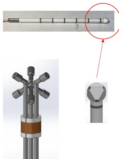
図3 一つの多面体で渦度を測定し、その空間分布を測定する新型プローブの鳥観図。
