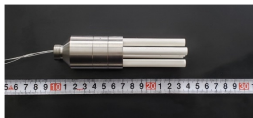
図3 RELAXで渦度だけでなく、磁場と電場を同時に測定するための複合プローブ。一つの円柱側壁に、多面体となるように電極孔が空けられている。(投稿準備中)
