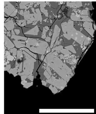
図2 Run Sc20 の実験生成物。柱状結晶が Sc-Czo。Scale bar = 100 \mu\text{m} 。
