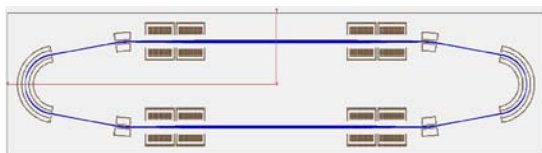
図4 Ar + を20 keVで入射したときのSIMIONのシミュレーション結果
