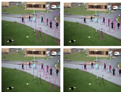
図 5. PETS 2009 View 01 に対する歩行者検出結果 (左上: HOG、右上: HOGHOF、左下: HOG3D、右下: STHOG(提案手法))
