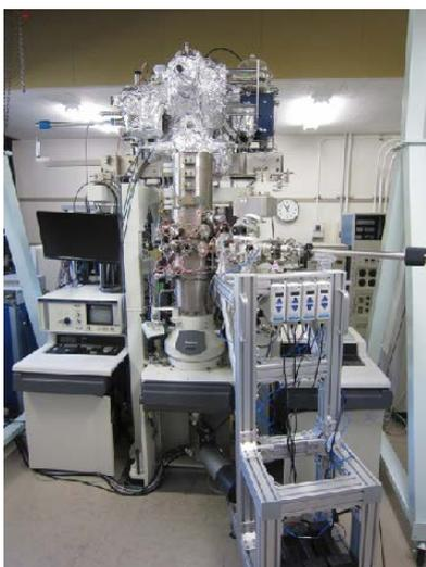
図2. 本研究にて開発に成功したスピン偏極透過電子顕微鏡の全体写真
