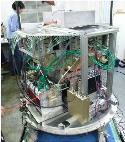
図2: bCALET-2の外観図。装置全体を円筒形の圧力容器(バツセル)におさめるため、装置下部にDAQシステムや電源を設置している。
