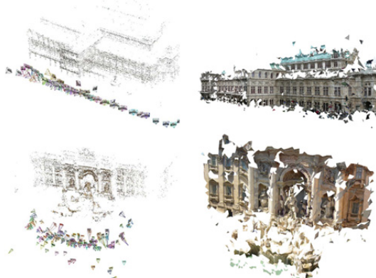
図 7: インクリメンタル SfM からのオンラインサーフェス生成の結果例. 左: インクリメンタル SfM の出力 (手前は撮影時のカメラ位置). 右: サーフェス生成結果.
