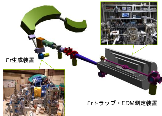
図1：左から一次ビームが導入され、表面イオン化器で生成された Fr が輸送系により中性化装置まで伝送される。その後、中性 Fr 原子は MOT で冷却・トラップされ、磁気シールド内の光格子に導き、EDM を測定する。
