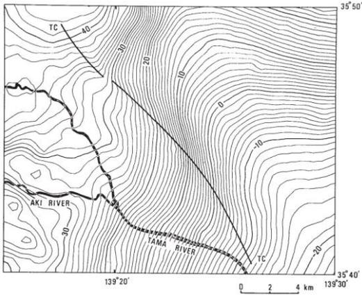
/03\_17. pdf) であるが、太い等高線間隔が 10 ミリガル ( $10^{-4}\text{m/s}^2$ ) であり、水平のスケールからすると重力の勾配の大きい所では 5 マイクロガル/m に達していることが分かる。活断層による重力異常もこのレベルである。地上の計測では、移動に要する時間と重力計の設置に要する時間、計測の時間を加味すると 1 地点の測定には 1 時間は要したと考えられ、上図を得るのに年の単位の時間がかかったことは容易に想像できる。この計測に代わって、広範囲の重力の変化を能率良く計るため、船、飛行機やヘリコプターなどの飛翔体を用いた探査が行われるのであるが、従来の重力計では計測精度に限界がある。
