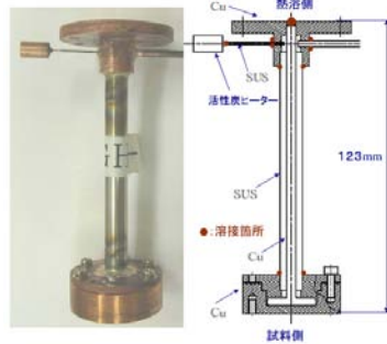
図 3. 国立天文台と協力して製作した新構造のガスギャップ式ヒートスイッチの写真と断面図。
