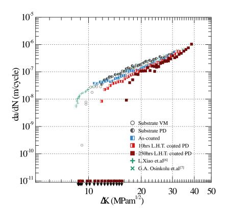
本手法によって疲労き裂を補修した Ni 基超合金モデル補修試験片のき裂進展抵抗と未補 修材との比較(これによれば、特に高温長時間時効を施すことにより、補修材のき裂進展 に対する下限界特性が向上することが示されている)
