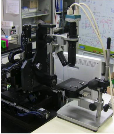
図4 ゼブラフィッシュトラッキング装置。XYZ ステージで高速カメラをホールドし、高速カメラの画像をPCで処理してステージを制御する。
