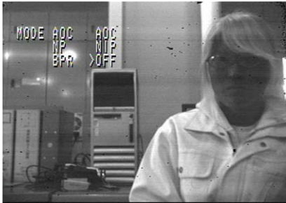
図6 試作した近赤外イメージセンサーの構造模式図(a)と撮像例(b)。なお、撮像は非冷却で撮影。
