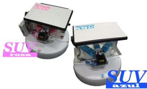
め、比較的柔軟な自律走行が可能である。また、地図と現在のセンサーの値を比較することで、人間などの地図には存在しない障害物を認識することが可能である。SUVはATと連携して走行することが可能であり、ATが自動走行を開始するとSUVはATよりも少し先を自律的に走行する。連携して走行する際に、ATに対して地図には存在しない障害物情報を逐次送信することで、ATは死角になっている領域の情報を補完することができる。
