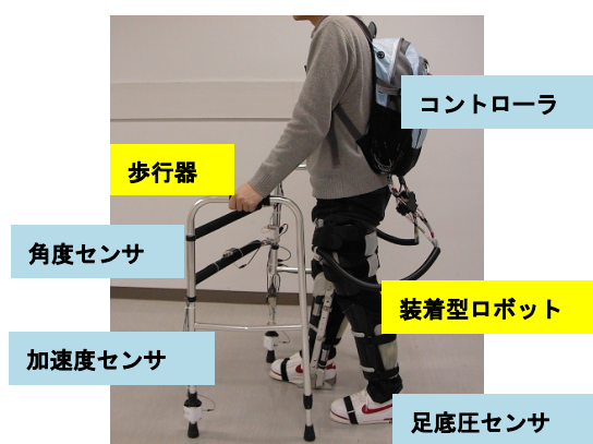
図1 装着型ロボットと歩行器を用いた二足歩行
