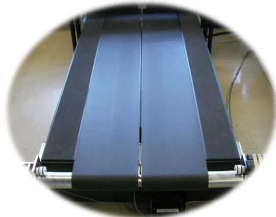
図 1 床反力計付両側分離型トレッドミル
