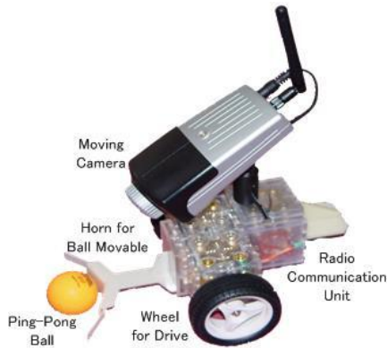
図1 先行研究のロボットの概略
