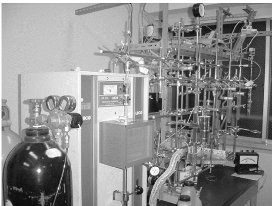
写真 RF加熱炉とCO 2 精製抽出用真空ライン
