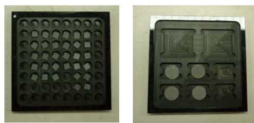
図 2 様々な計上をしたルミネセンス線量計を黒色ポリカーボネートのホルダーに詰めた。異なるグループの別の線量計と同じホルダーになることもあった。
