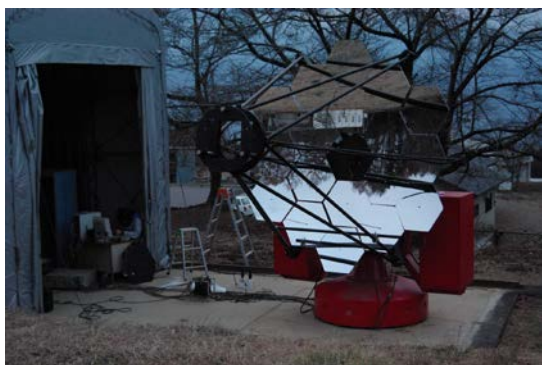
図 7：光学系の再構築後の明野 IACT。
