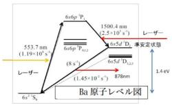
S,P,D の3準位について、 D準位は~0.1秒 の長寿命であり、準安定である。この点から、 Ba 原子を使うことを決めた。これを蒸気の状態で封入して実験を行う。まず、基底状態にある電子に対して、 554nm と 1500nmの両方のレーザーを照射する。この時、レーザーパワーを選ぶことで、短期間にコヒーランスの高い暗黒共鳴状態を作成する。ここからの波長 878nm の蛍光を観測することで、暗黒共鳴の生成及び超放射を同定する。
