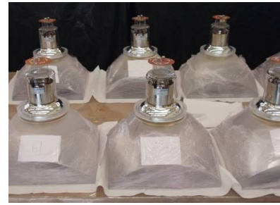
BiPo 検出器のプラスチックシンチレーターと光電子増倍管
