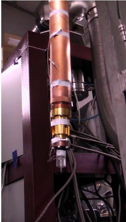
図4 コールドフィンガーに取り付けられたポメラランチュセル 先端のポリカーボネートが $^3\text{He}$ セル。
