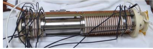
図2 超高速イメージ撮像管
