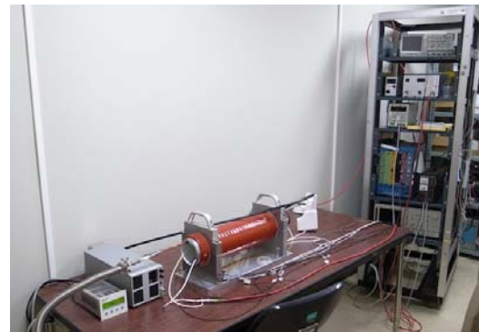
図3 超高速イメージ撮像管の試験の様子。撮像管は中央のソレノイド電磁石に組み込んでいる。手前は真空計と電磁石電源。右のラックに制御電源等の回路がある。
