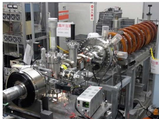
図2 陽電子プローブマイクロアナライザーの写真
