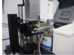
図2. 構築した RHEO-ATR-FTIR 装置
