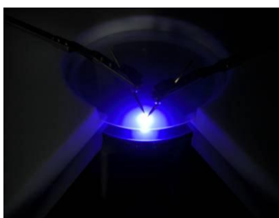
図 5 試作した紫外 LED 構造の a) 各電流の発光スペクトルと b) 100 mA 通電時の発光。活性領域は構造改善を試みたものの結果である。
