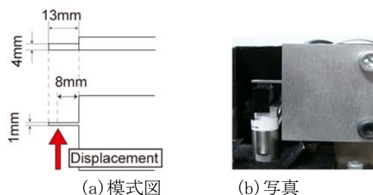
図 1 計測試料 (小型カンチレバー)
