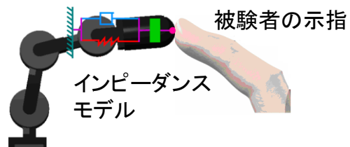
図4 指ロボットの力制御（指先インピーダンス制御）（図1の[4]）
