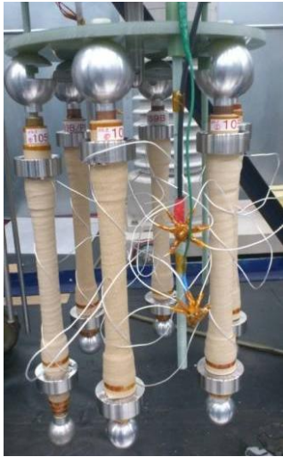
図1 超伝導ケーブルの電気絶縁構造を模擬したサンプル電極
