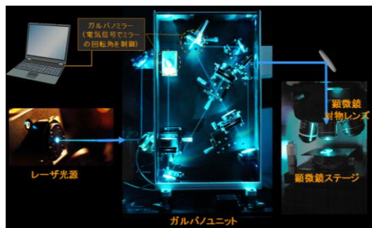
図2 ガルバノミラーを用いた高速レーザー描画装置.
