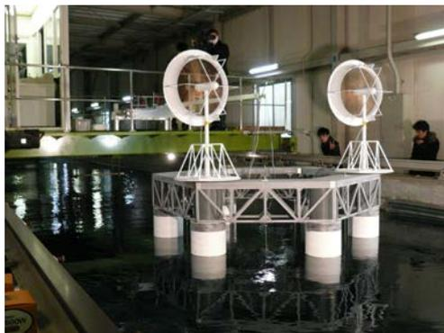
ので風車と浮体の連成運動を考慮する必要がある。本研究では、洋上風力発電用の浮体の模型を用いて水槽実験を実施した。下図は、今回の実験で用いられたブレード直径 512mm、ディフューザ直径 693mm の風レンズ風車を搭載した直径 2.4m の六角形浮体の模型の写真である。水槽は、応用力学研究所の長さ 65m、幅 5m の深海水槽であり、水槽内に送風機を一時的に設置して実験を行った。浮体の係留は、6本のピアノ線を用いて TLP(Tension Leg Platform)法によった。模型実験の概略を下図に示す。
